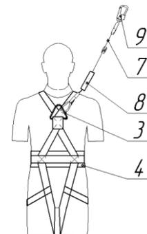
1 - ремень; 2 - пряжка ремня; 3 - кольцо (элемент крепления); 4 - кушак; 5 - лямка наплечная; 6 - лямка набедренная; 7 - гибкий элемент стропа; 8 - амортизатор; 9 - карабин (элемент соединительный)
