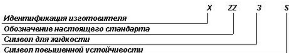
**2 Маркировка оправы (корпуса) для защиты от грубодисперсных аэрозолей**
