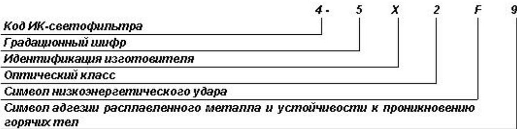
**7 Светофильтры для сварки и других тепловых процессов с усиленным отражением**
