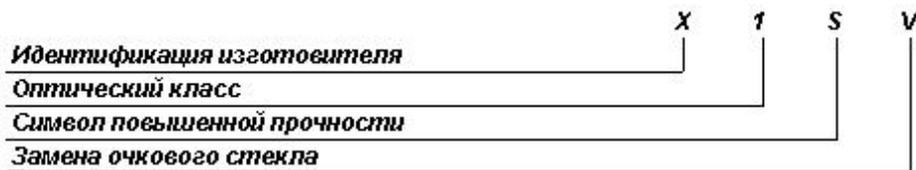
**10 Защитное очковое стекло без фильтрующего эффекта и самым высоким значением механической прочности при экстремальных температурах**
