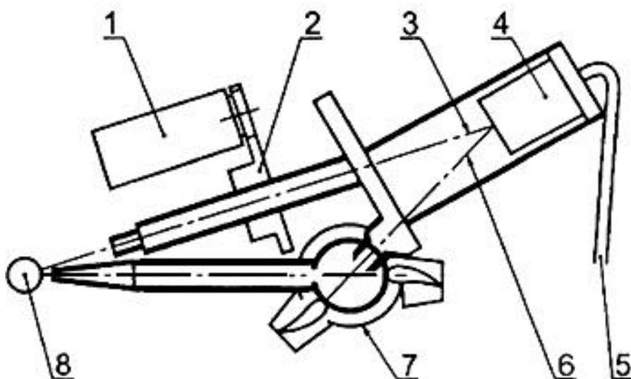
1 - регулирующий мотор; 2 - регулятор пучка; 3 - пучок прямого света  $I_0$ ; 4 - фотоумножитель; 5 - усилитель;
