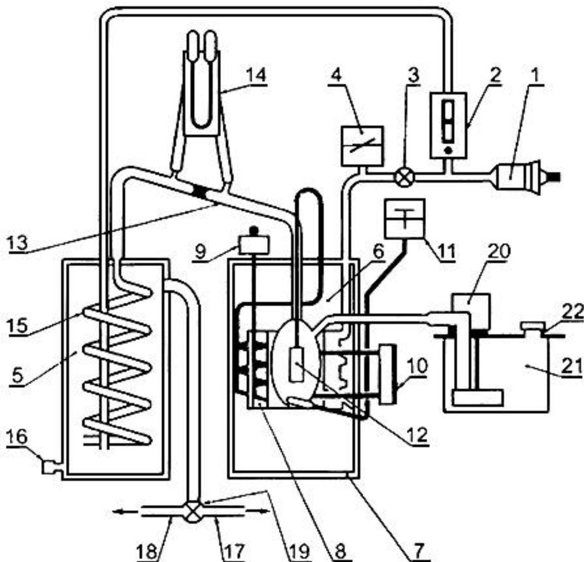
1 - впускное отверстие с воздушным фильтром для поступления воздуха под давлением 500 Па;
