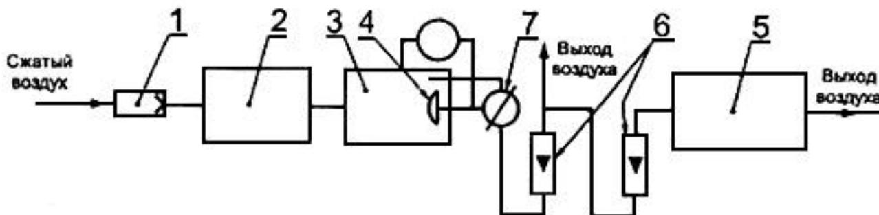
1 - воздушный фильтр; 2 - генератор аэрозоля; 3 - испытательная камера; 4 - образец;
