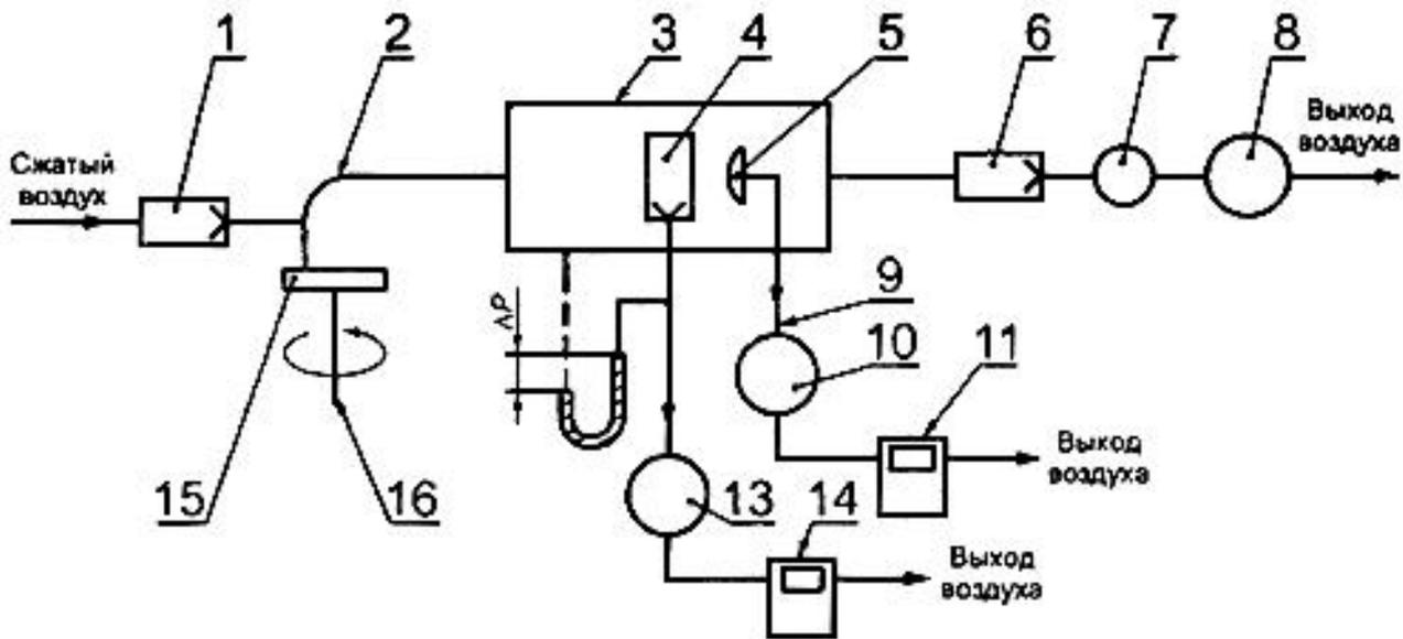
1 - воздушный фильтр; 2 - инжектор; 3 - испытательная пылевая камера; 4, 6 - фильтр; 5 - зонд;
