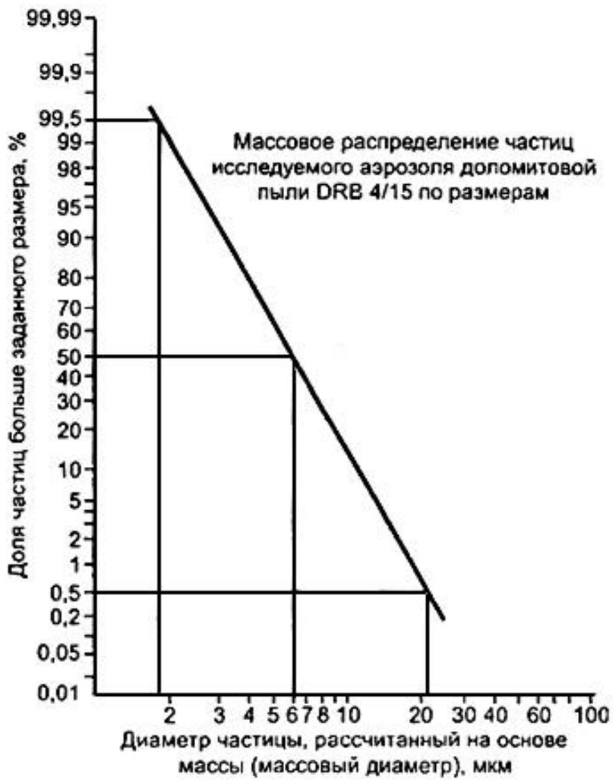
Постоянный поток воздуха через пылевую камеру  $60 \text{ м}^3/\text{ч}$ , линейная скорость  $4 \text{ см/с}$ .
